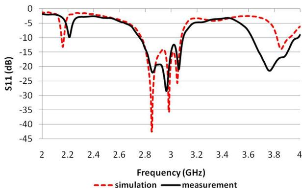
Fig 7.  $S_{11}$  parameter of the antenna
