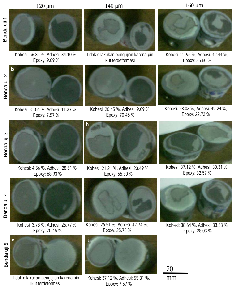
Gambar 5. Bentuk perpatahan sampel uji lekat coating pada temperatur aplikasi 240 °C dengan ketebalan (a-e) 120 \mu\text{m} , (f-j) 140 \mu\text{m} , dan (k-n) 160 \mu\text{m}
