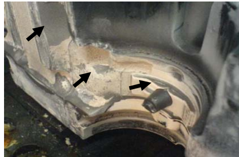
Gambar 9. Kegagalan adhesif coating (tanda panah) pada uji coba (trial)
