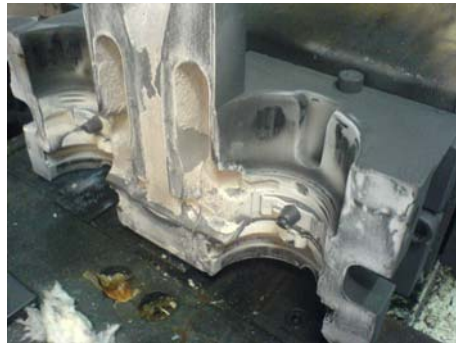
Gambar 7. Kegagalan adhesif coating pada uji coba
