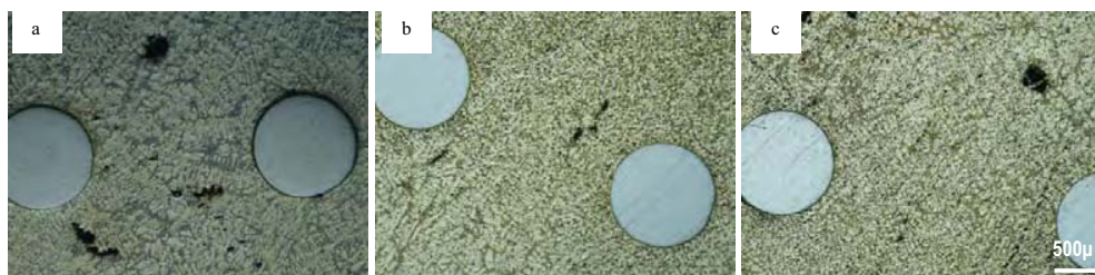
Gambar 5. Daerah antarmuka kawat tali baja dan matriks paduan Al-7Si dengan kandungan 0.31 % Mg yang tidak menunjukkan adanya void pada jarak : (a) 1.49 mm; (b) 1.66 mm; (c) 2.17 mm
